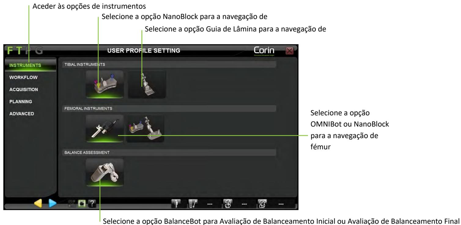
**Modificar as opções de instrumentos:** Toque no separador de Instrumentos e selecione a opção de instrumento preferido para navegação de corte Tibial e Femoral, assim como a opção de instrumento preferido para o Balanceamento de Ligamentos.
