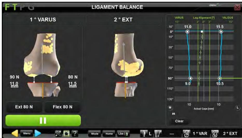
As lacunas exibidas são corrigidas em 2 mm para compensação da espessura extra do Implante de Tíbia Modular
