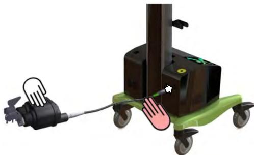
Mantenha o OMNIBot e a maior parte do cabo de ligação sobre a mesa de operações e entregue a outra ponta do cabo ao pessoal não estéril para ligação ao conector OMNIBot na Estação OMNIBotics. O ponto vermelho no conector deve ficar alinhado com o ponto vermelho na porta de ligação da Estação.
