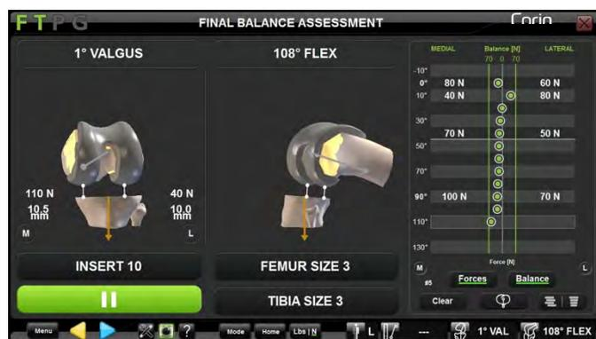
**Observação:** Durante Avaliação de Estabilidade Final no Modo de Controlo de Altura, é possível exibir imagens em direto exibindo o nível de balanceamento entre os dois compartimentos da articulação do joelho. Linhas indicando 70 N de desequilíbrio entre o compartimento medial e lateral no gráfico são representadas para ajudar o utilizador a avaliar o nível de balanceamento. Para ativar esta opção, toque no botão **Balance** no ecrã.
